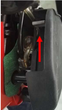
Klapa startowa otwarta (dźwignia kłapy startowej w górę)
